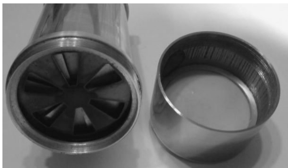
Rys.4. Dozymetr elektretowy, a - widok z odłączoną komorą jonizacyjną zawierającą elektret, b – widok dozymetru
