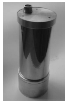
Rys.4. Dozymetr elektretowy, a - widok z odłączoną komorą jonizacyjną zawierającą elektret, b – widok dozymetru
